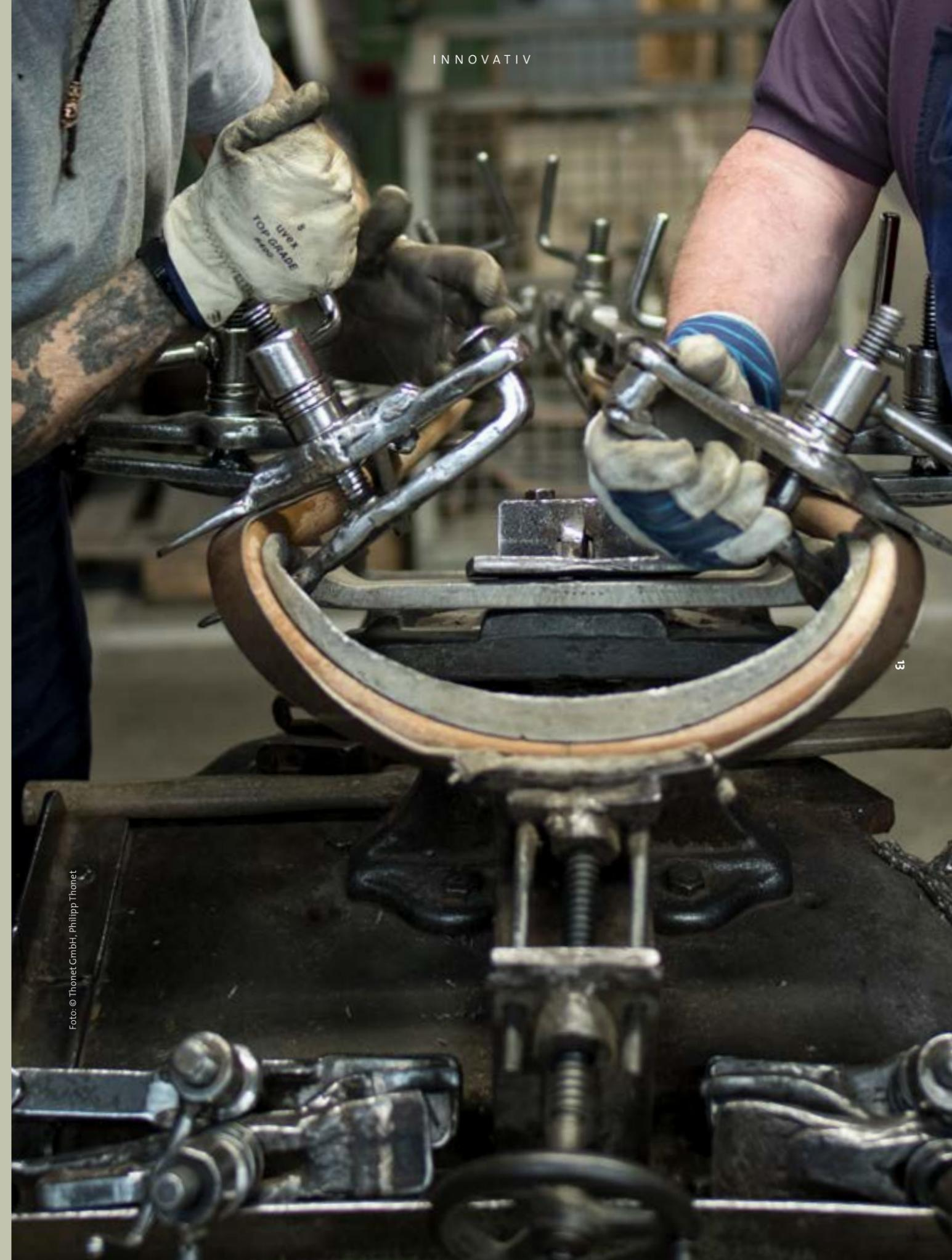
Erst anschließend kann es in der Biegeform fixiert und durch vollen Körpereinsatz von bis zu vier Bieger:innen gleichzeitig in die gewünschte Form gezogen und gedreht werden. Damit das gebogene Holz seine Form behält, wird das Holz in seiner Biegeform nun für zwei Tage in der Trockenkammer gelagert. Auch aus heutiger Sicht ist die Herstellung von Bugholz eine Innovation – und längst nicht die einzige des Unternehmens.
